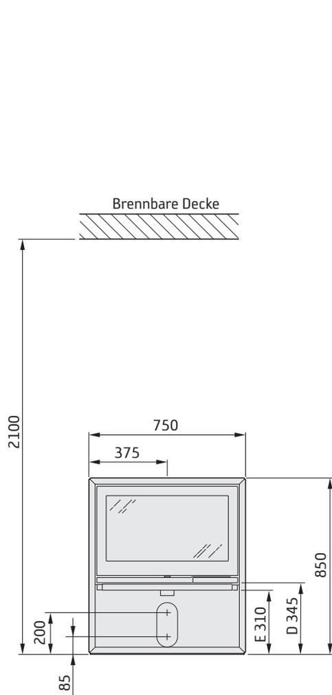
Der Mindestabstand zwischen Kaminofenöffnung und einem brennbaren Gebäudeteil oder Einrichtungsgegenständen beträgt 1,4 m.
