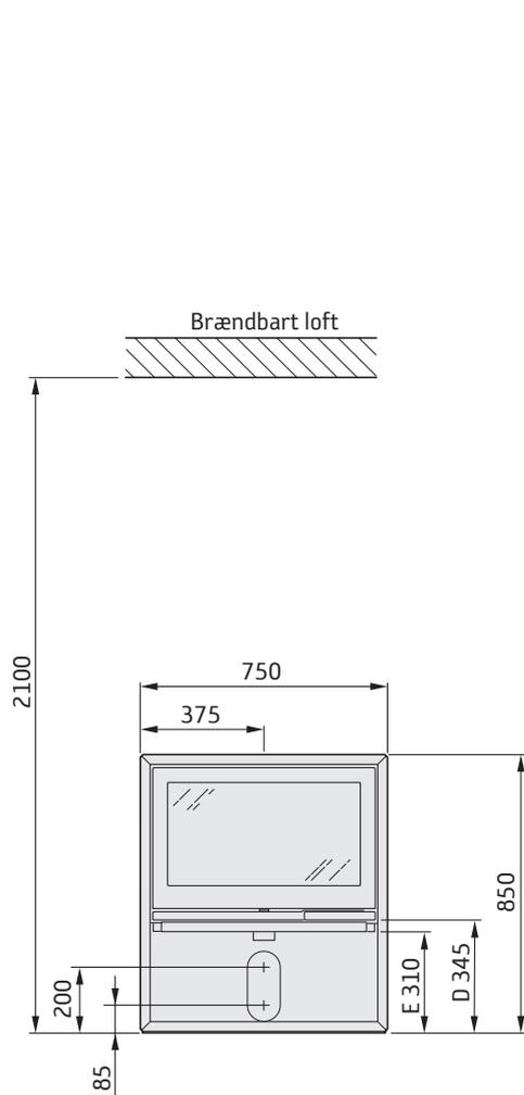
Der skal være mindst 1,4 meter foran brændeovnens åbning til brændbare bygningsdele eller indbo.
